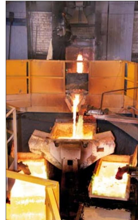
Река расплавленной меди устремляется по проложенному руслу к разливочной машине.
